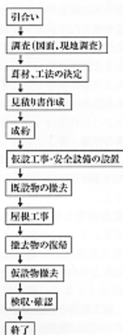
図2 屋根改修工事のフロー
