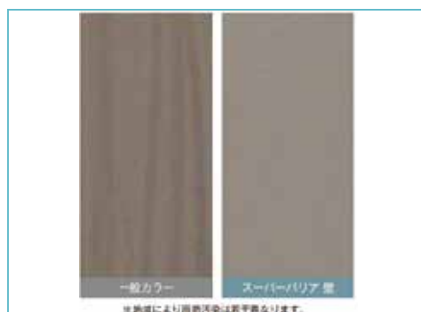
図 13 雨筋汚染暴露試験（一年経過後）
