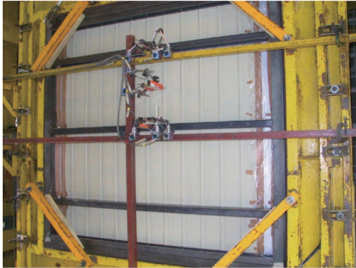
写真7 耐風圧性試験体と変位計設置状況(差し込み形の場合)
