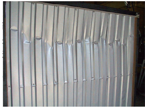
写真8 耐風圧性試験結果の例(重ね形の場合)
