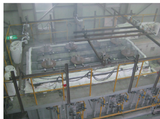
図6 試験終了後の試験体の状況(非加熱面)
