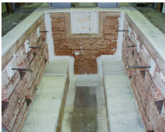
図3 耐火試験炉の概要(炉内)
