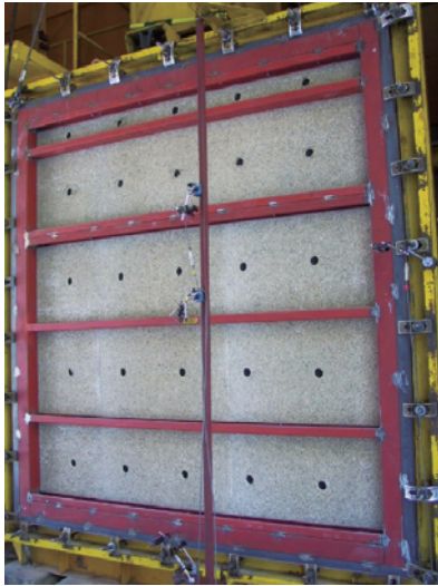
写真2 圧力箱に取り付けられた試験体 (野地板の屋内面が見える)
