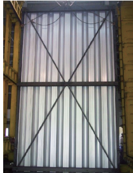
写真3 折板試験体 (室内側)
