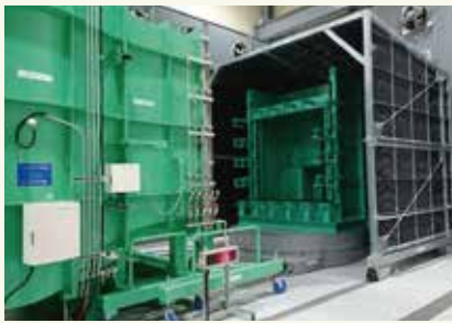
角波の送風散水試験
