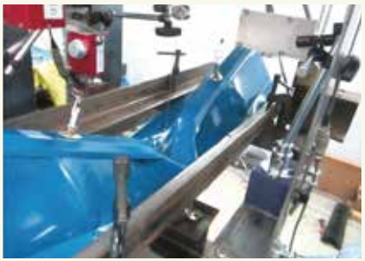
重ね形折板の接合部耐力試験
