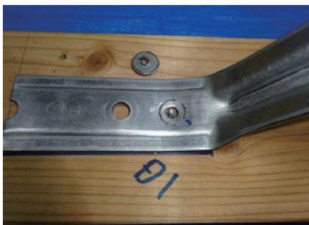
木造での折板接合部確認試験
